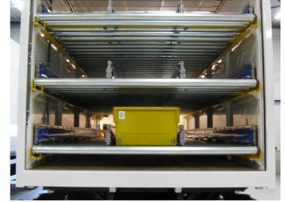
*BAUR Versand ist Teil der Otto-Gruppe und ein grosses Internet- und Versandunternehmen in Deutschland. Ancra Systems haben ein automatisches LKW Be- und Entladesystem in drei Wechselbrücken installiert. Die Wechselbrücken pendeln ( $\pm 2$  km) zwischen dem computergesteuerten Zentrallager und dem Distributionszentrum, wo Aufträge kommissioniert werden.*
